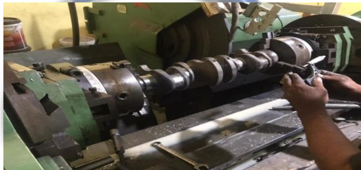
Gambar 4.1 Ukur crankshaft dengan mikrometer
