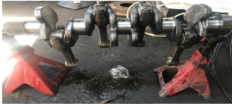
Gambar 4.6 Uji putaran pada stand crankshaft
