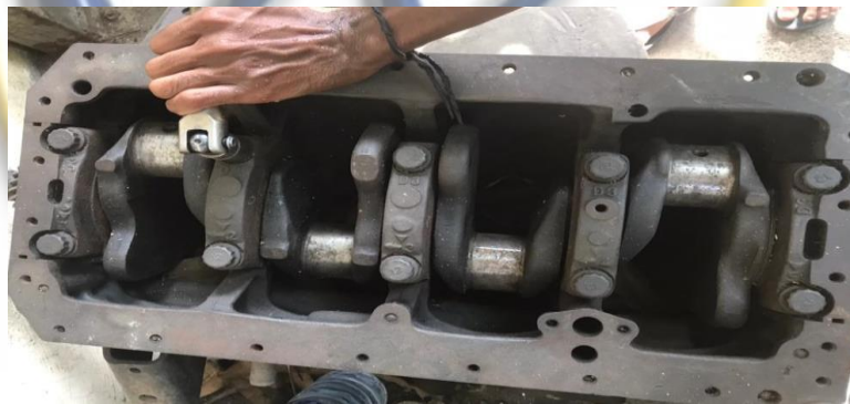
Gambar 4.7 Proses pasang crankshaft pada frame
