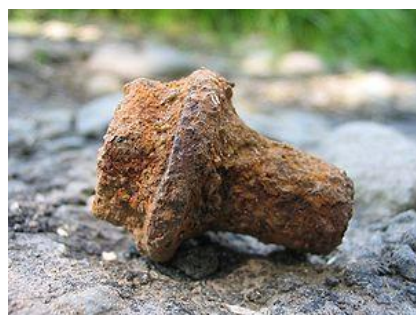
Gambar 2.5.3: korosi elektrolit oleh kandungan garam.
