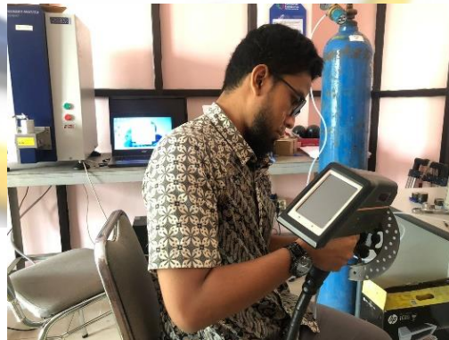
Gambar 3.5 Mesin Uji Komposisi Kimia (sumber :Dokumentasi sendiri)
