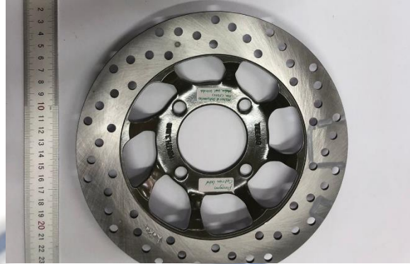
Gambar 3.4 Disc Brake Lokal (sumber: Dokumentasi Pribadi)
