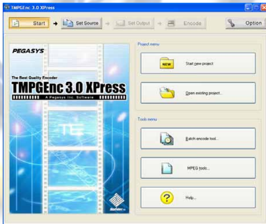
Gambar 3.18 Setelah proses rendering selesai lalu diteruskan kepada software TMPEnc 3.0 XPRESS untuk membuat file avi menjadi mpeg .
